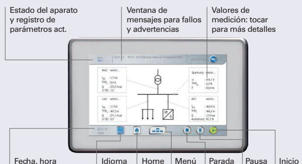
Además, el GRIDCON® ACF también puede manejarse basado en la web. Tras la integración en una red empresarial o a través de una conexión de radiotelefonía móvil, puede leerse y parametrizarse remotamente mediante un navegador.
